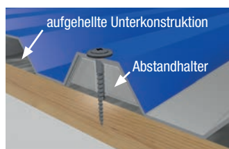
Querschnitt Befestigung der Überlappung
